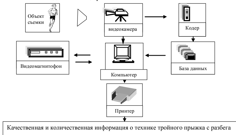
Рис 1. Блок-схема видеокомпьютерного анализатора движений «АСОВ».
